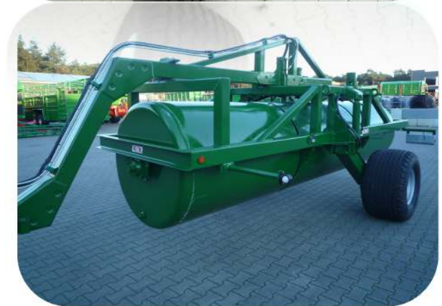
Fahrgestell, Bereifung 500/50-17 mit 1-Kreis Druckluft- bremse
