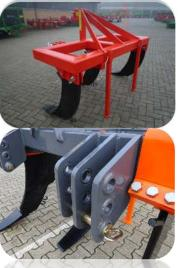
Superschwere und sehr stabile Ausführung für Dreipunkt-Heckanbau, verschiedene Arbeitsbreiten, Rahmenhöhe 850 mm, Arbeitstiefen bis 800 mm, Zinkensicherung mit Abscherbolzen, auswechselbare Schare. Segarvreute 100/190 mm, Scharhöhe 350 mm
