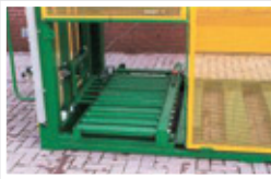
Einfuhrrollenbahn zum Ausgleichen des Sackes
