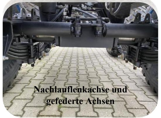
**Nachlaufkchse und gefederte Achsen**
