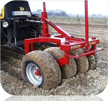
Superstabile Ausführung mit Lenkeinrichtung, Hauptrahmen 150 x 100 mm, Große Reifen: 11.5/80 - 15.3 10 PR, Reifendurchmesser ca. 840 mm, Reifenbreite ca. 290 mm, Arbeitsbreite ca. 1500 mm, Federdruckausgleich, Abstellstützen, Gewicht ca. 400 kg
