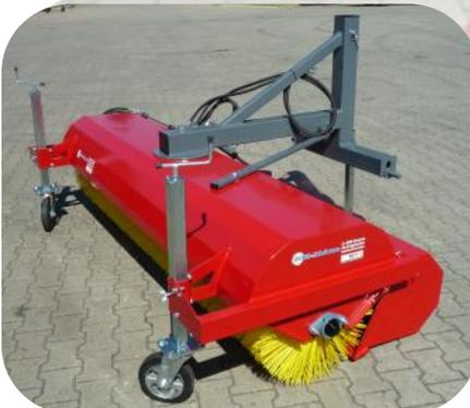
Anbaukehrmaschinen für Schlepperdreipunkt in Heckanbau, Kat. II, PPN-Kehrwalze mit 520 mm Ø, hydraulische Wannentleerung, Spritzschutz, hydraulischer Antrieb mit Schläuchen und Kupplungen, Schrägstelleneinrichtung, höhenverstellbare Stützräder mit Metallfelgen, Extra Lagerung am Hydraulikmotor.
