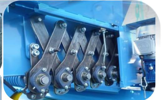
Geräuscharmer Kettenantrieb mit 7 Walzen, Wahlweise: Stahlspiralen, PU Walzen oder Glattwalzen, 90 mm Durchmesser, Im Abstand von 10 - 80 mm stufenlos verstellbar, Neigung stufenlos verstellbar, stufenlose Geschwindigkeitsverstellung gegen Mehrpreis, Ein- und Auslaufrutsche, Höhenverstellbares Standgestell mit Einfahrflaschen für Gabelzinken.
