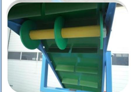
Für Sortierer, Kisten, Bunker, Big-Bags, Anhänger etc., Fahrgestell mit Räder, Höhenverstellung über Winde, gummierter Einlaufrichter, Stollenhöhe ca. 60 mm, Stollenabstand ca. 250 mm, eigene Herstellung und pulverbeschichtet
