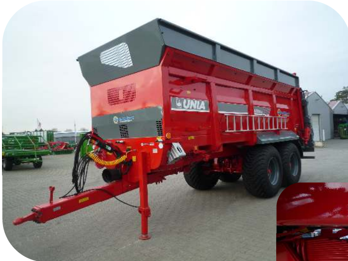
Ab Tytan 24 Untenanhängung mit Deichselfederung
