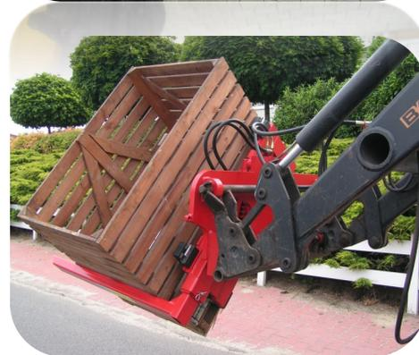
Ausführung mit schwerem Drehkranz, anbaubar an Gabelstapler und an Frontlader, drehbar um 180°, linksdrehend, mit einsteckbarer seitlicher Drittgabel, Schläuchen und Kupplungen, eigene Herstellung und pulverbeschichtet (FL = Frontladergerät), 1000 mm Gabelträgerbreite
