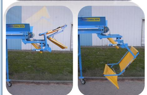
Automatische Kistenfüllgeräte zum einseitigen Befüllen von Kisten oder beidseitig im Wechselbetrieb mit Sensorenschaltung und automatischer Um- und Abschaltung, Wahlschalter für Hand- und Automatikbetrieb, **Eigene Herstellung und pulverbeschichtet**
