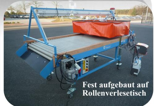
Auch für vorhandene Rollenverlesetische geeignet. Zur Bebeizung vor dem Auspflanzen, Bekämpfung von Lagerfäule, Keimhemmung usw., Anschluß 220 Volt, Automatische Geräteabschaltung (AGA) sowie eine Signallupe mit Warnlicht (12 V) gehören zum Standardlieferumfang
