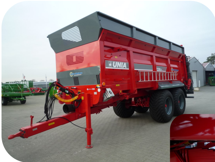
Ab Tytan 24 Untenanhängung mit Deichselfederung
