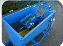
Zum Beispiel als Puffer vor Absackwaage oder vor der Sortieranlage, Jeweils mit Austragband ca. 320 mm breit mit stufenloser Geschwindigkeitsregulierung, Motor 0,37 kW/400 V, Regelbereich von 0,10 bis 5,5 m/min, 10 m Kabel mit Fernbedienung, **Eigene Herstellung und pulverbeschichtet**
