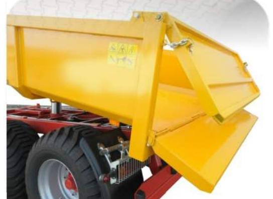
zusätzliche pendelnde Flügel-Heckklappe
