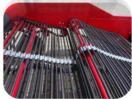
Für Reihenweite 750 mm — 900 mm. 2 Reihen mit 2 Ketten für Dreipunktanbau und Ablage nach hinten. Antrieb über Gelenkwelle, jeder zweite Stab ist gummiüberzogen. Rütteleinrichtung, 2 luftbereifte Stützräder, 2 Scheibenseche mit 600 mm Ø
